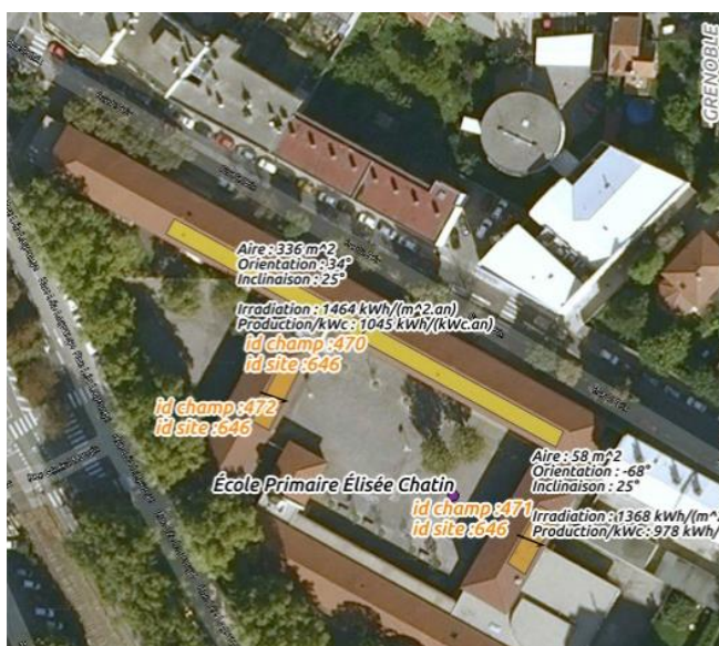
Photographie aérienne de la toiture de l'école Elisée Chatin, exploitable selon les critères choisis (logiciel QGIS)
