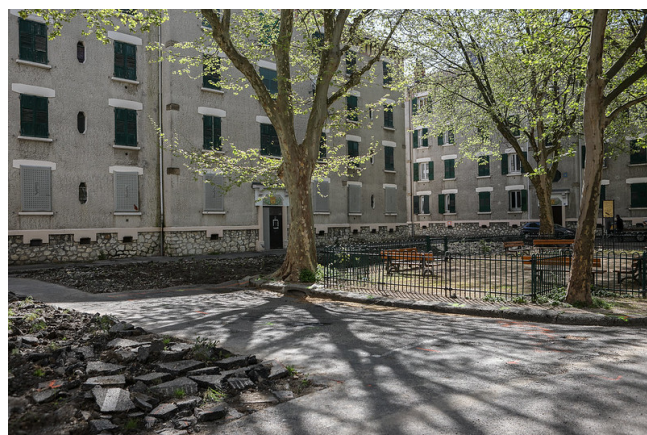
Quartier de l'Abbaye, rénovation urbaine, bitume retourné et transformé en terrain de plantations.
